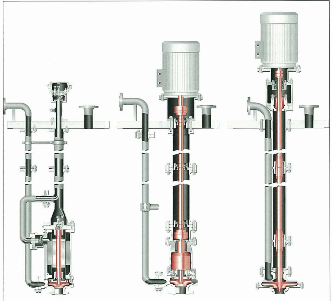
▲ Abb. 4 Vergleich der drei Tauchpumpen-Bauarten
