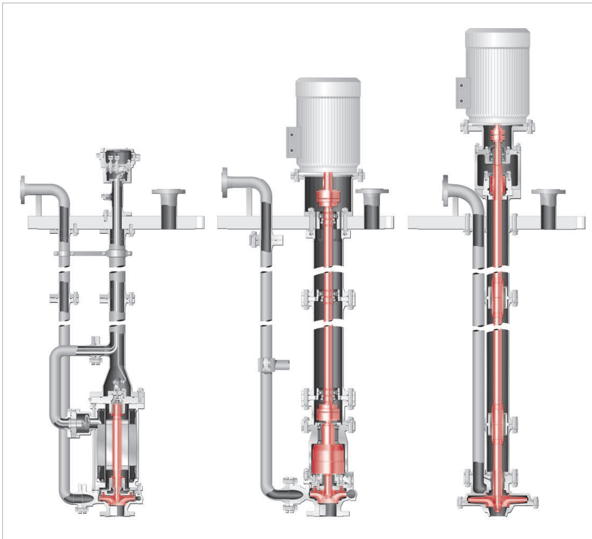
Figure 4: Comparaison des trois types de pompes immergées
