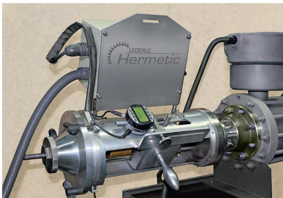
*Überprüfung und Messung des ZART-Prinzips: Über ein speziell entwickeltes Messgerät werden hydrodynamische Rückstellkräfte erfasst und protokolliert*
